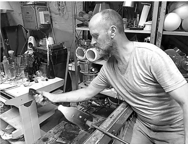
Abb 1: Beim Auftreiben des erwärmten Flaschenhalses
